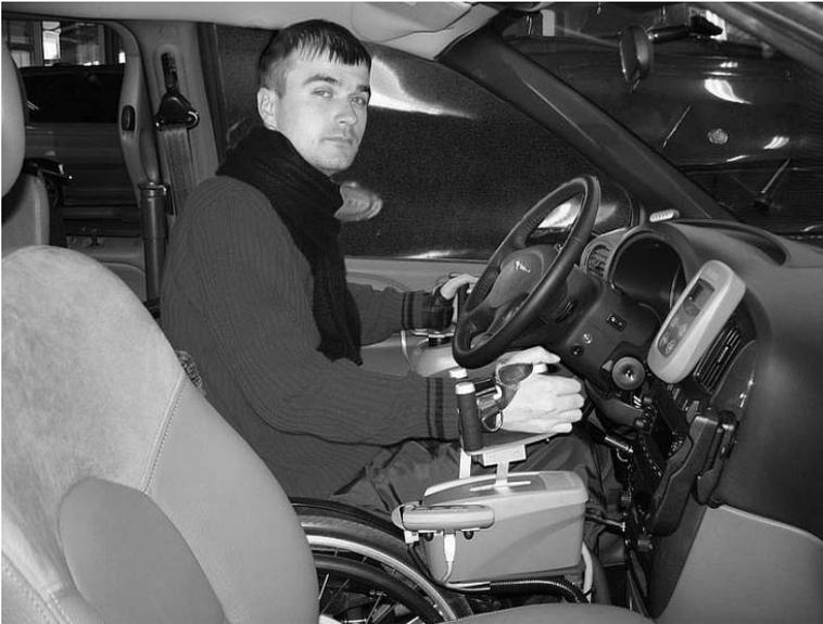
**Abb. 15:** Es gibt bereits reine Steer-by-Wire- als auch Drive-by-wire-Systeme im Sonderfahrzeugbau für mobilitätseingeschränkte Fahrer, redundant ausgelegt und TÜV-zugelassen. Die linke Hand steuert ein Mini-Lenkrad, die rechte den Schubhebel (Quelle: Paravan GmbH)
