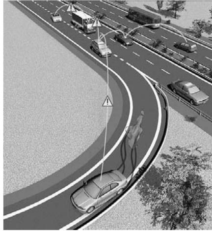
**Abb. 21:** Lokale „Car-to-Car“-Kommunikation (Quelle: CAR 2 CAR Communication Consortium)
