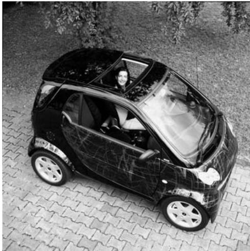
**Abb. 4:** Das homogen und hochwertige Erscheinungsbild des Dachmoduls des Smart wird möglich durch mehrschichtige Kunststofffolien (Quelle: BASF)
