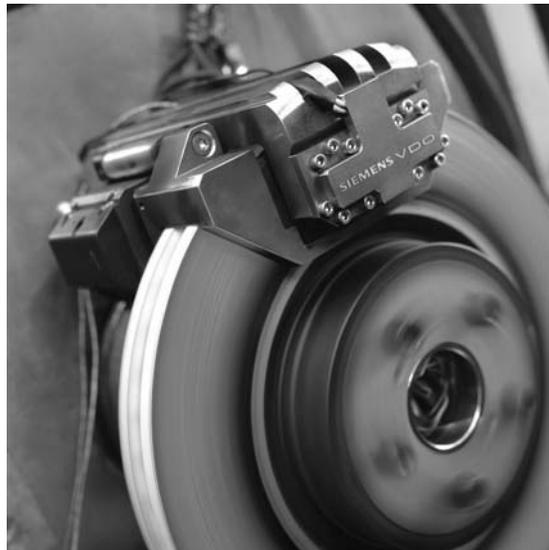
**Abb. 16:** Eine elektronische Keilbremse wird auf dem Bremsenprüfstand getestet (Quelle: Continental/Siemens VDO)
