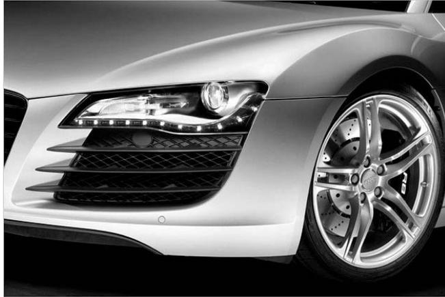
**Abb. 22:** Der erste Voll-LED-Scheinwerfer mit 54 Leuchtdioden im Audi R8 (Quelle: Audi)
