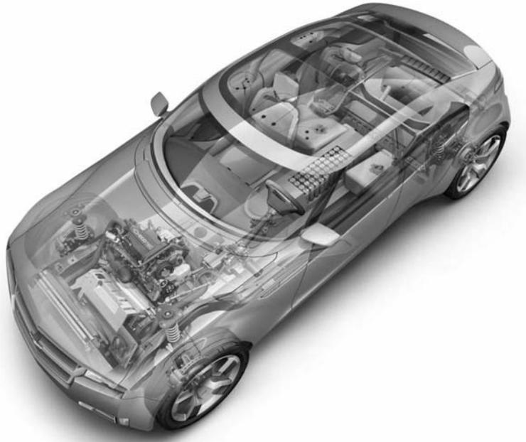
**Abb. 10:** Konzeptfahrzeug Chevrolet Volt: ein 1,0-Liter-Dreizylinder-Turbobenzinmotor erzeugt mit konstanter Drehzahl Strom, um die Batterien im Mittelunnel wieder aufzuladen (Quelle: General Motors)
