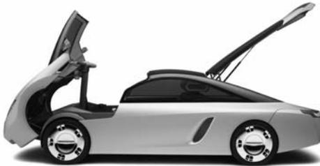
**Abb. 25:** Das „Low Resistant Mobile“ mit geöffneter Fronttür und Heckklappe (Quelle: Loremo AG)
