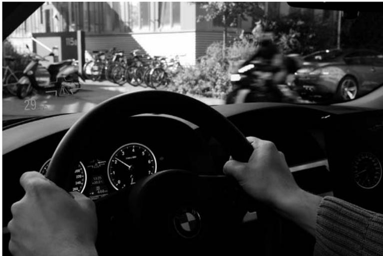
**Abb. 20:** Der Querverkehrsassistent warnt über ein Head-up-Display auf der Windschutzscheibe vor bewegten Objekten außerhalb des direkten Sichtfeldes des Fahrers (Quelle: BMW Group)
