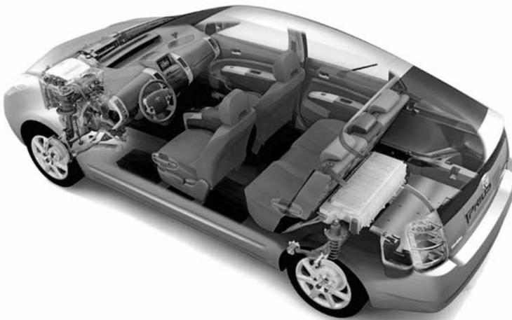
**Abb. 9:** Einblick in einen Toyota Prius: der Elektromotor befindet sich neben dem Verbrennungsmotor, die Batterie hinter der Rücksitzbank (Quelle: Toyota)
