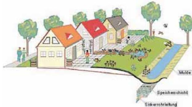
Abbildung 18: Mulden-Rigolen-System zur Versickerung von Grundwasser in einem Wohngebiet; schematische Darstellung. (Quelle: Stadt Münster, Tiefbauamt)
