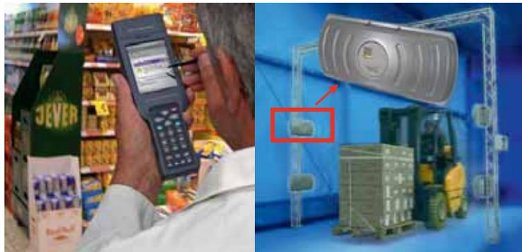
Abb. 8 Links: Handterminal DT-X11 mit RFID-Modul für HF- oder UHF-Tags (Quelle: CASIO Europe, Norderstedt). Rechts: RFID-Reader der Fa. Deister electronics für den Einsatz in RFID-Gates mit einer Reichweite von bis zu fünf Meter (Quelle: Deister electronic GmbH, Bearbeitung durch ZTC der VDI Technologiezentrum GmbH)
