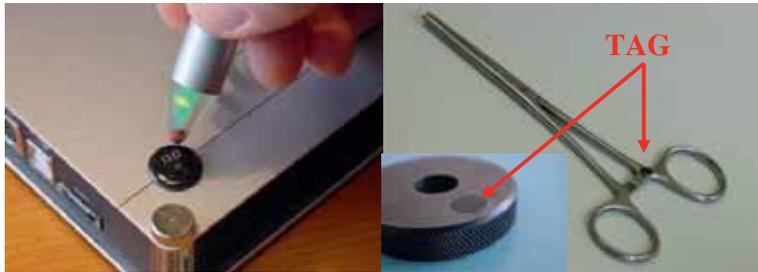
Abb. 10 RFID-Transponder in metallischer Umgebung. Links: RFID-Transponder auf metallischer Oberfläche im Multimedia-Bereich. Rechts: RFID-Transponder zur Kennzeichnung medizinischer Geräte und in einem metallischen Bauteil integriert (Quelle: microsensys GmbH, Erfurt)
