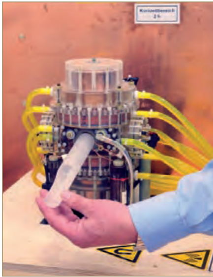
Experimentelles MPI-System für Bildgebung an Mäusen (Foto: Philips, Hamburg).
